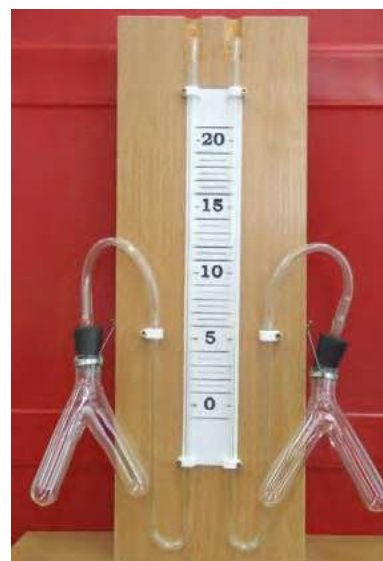
Рис. 19. Прибор для определения скорости химических реакций
