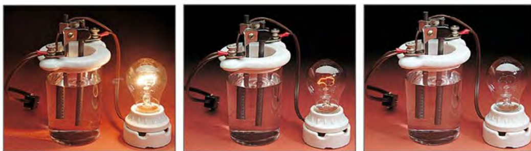
Рис. 23. Приборы для измерения электропроводности веществ
