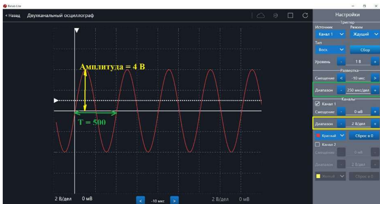
Рис. 42. Определение параметров осциллограммы
